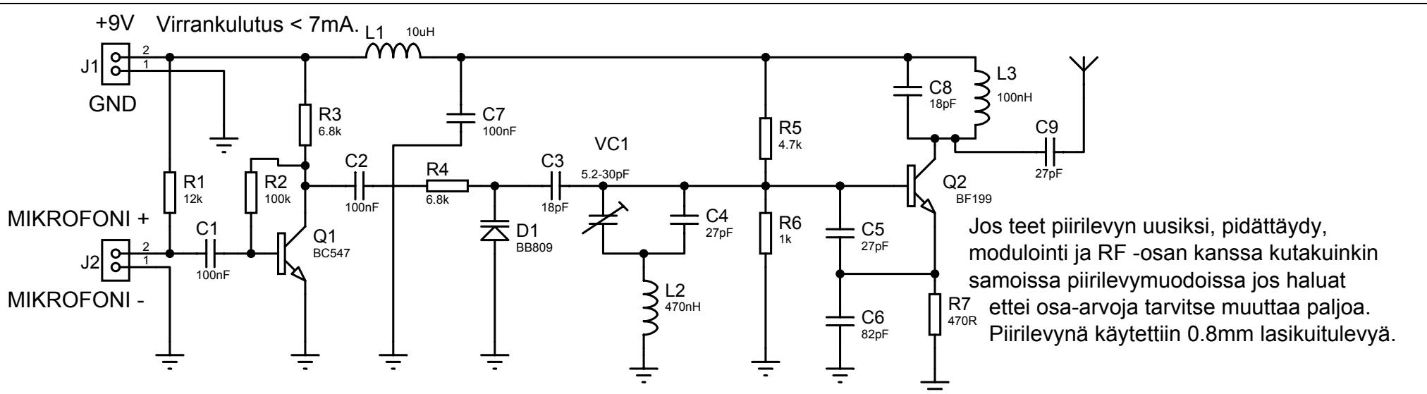
Jos teet piirilevyn uusiksi, pidättäydyt, modulointi ja RF -osan kanssa kutakuinkin samoissa piirilevymuodoissa jos haluat ettei osa-arvoja tarvitse muuttaa paljoa. Piirilevynä käytettiin 0.8mm lasikuitulevyä.
